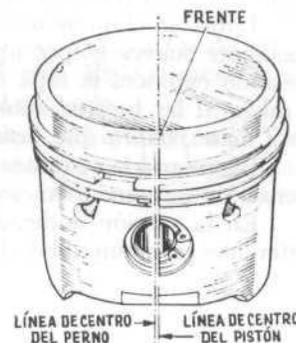
FIG. 31. Desplazamiento del perno con respecto a la línea de centro del pistón.
