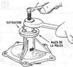
FIG. 67. Desmontaje de la maza del ventilador.
