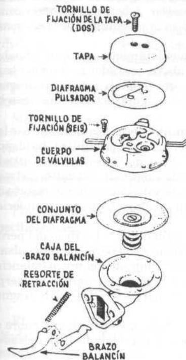
FIG. 63. Componentes de la bomba de combustible
