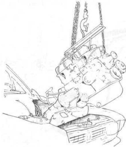
FIG. 4. Extracción del motor juntamente con la caja de velocidades.
