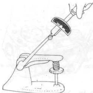
FIG. 13. Prueba de la tensión de los resortes.
