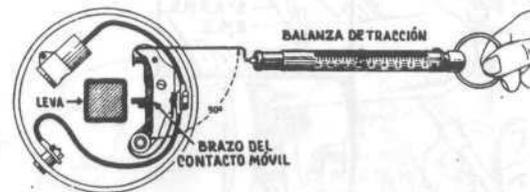
FIG. 78. Comprobación de la tensión del resorte del contacto móvil.
