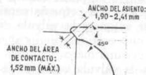
FIG. 17. Área de contacto y ancho del asiento de una válvula correctamente rectificada.
