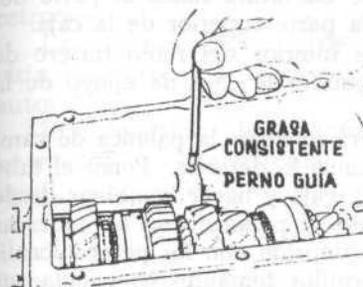
FIG. 106. Colocación del perno guía del eje selector de marcha atrás.
